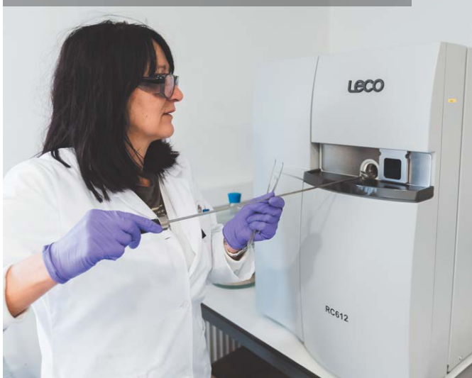
Metoda LECO test za določanje ostankov maziv na površini folij
